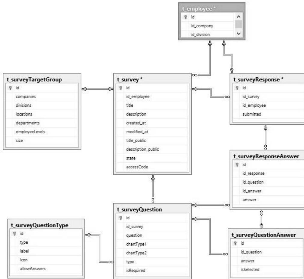
**Figure 28. Database Diagram**
